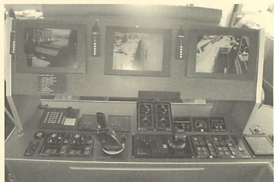
後進着岸用操船パネル。3つのビデオ画面が船の周りを写す。
